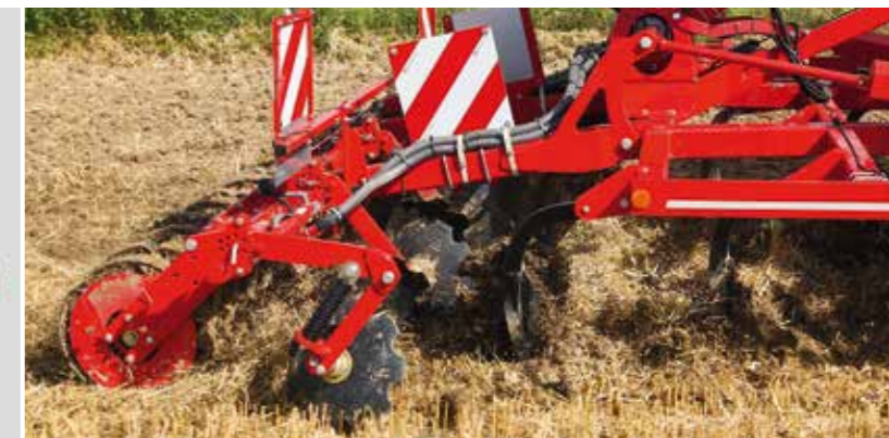
Terrano 3 FX mit shear bolt protection
