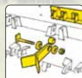
Coltello universale per stocchi di mais, tabacco, ecc. Universal blad for stubbles, tabacco, etc.
